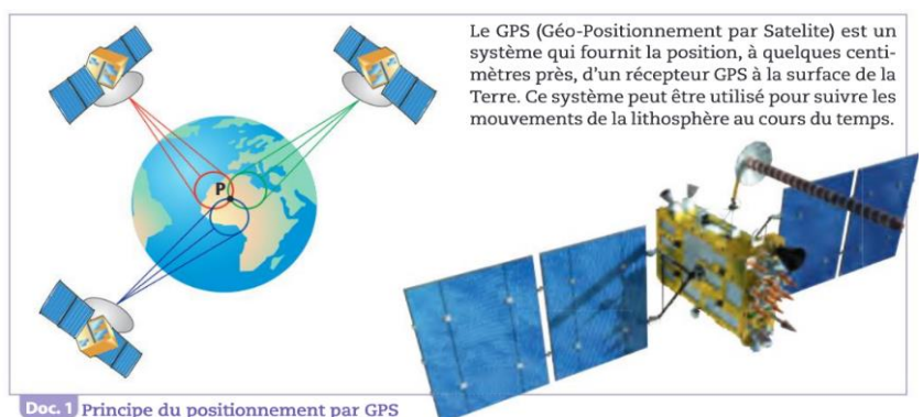
Doc. 1 Principe du positionnement par GPS
